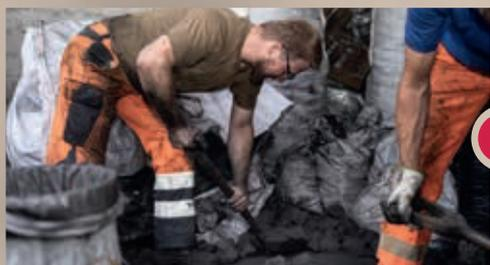
Damit nicht eine Unmenge an Rauch erzeugt wird, fährt das Dampftram mit einer speziellen Zusammensetzung aus Kohle und Koks. Tobias de Stoutz, Mitarbeiter von BERNMOBIL, bereitet die Mischung für die nächste Fahrt vor.
