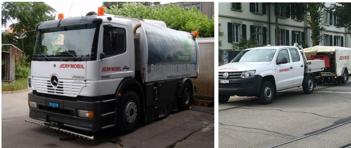
Abb. 18 Schienenreinigungs-Fahrzeuge
